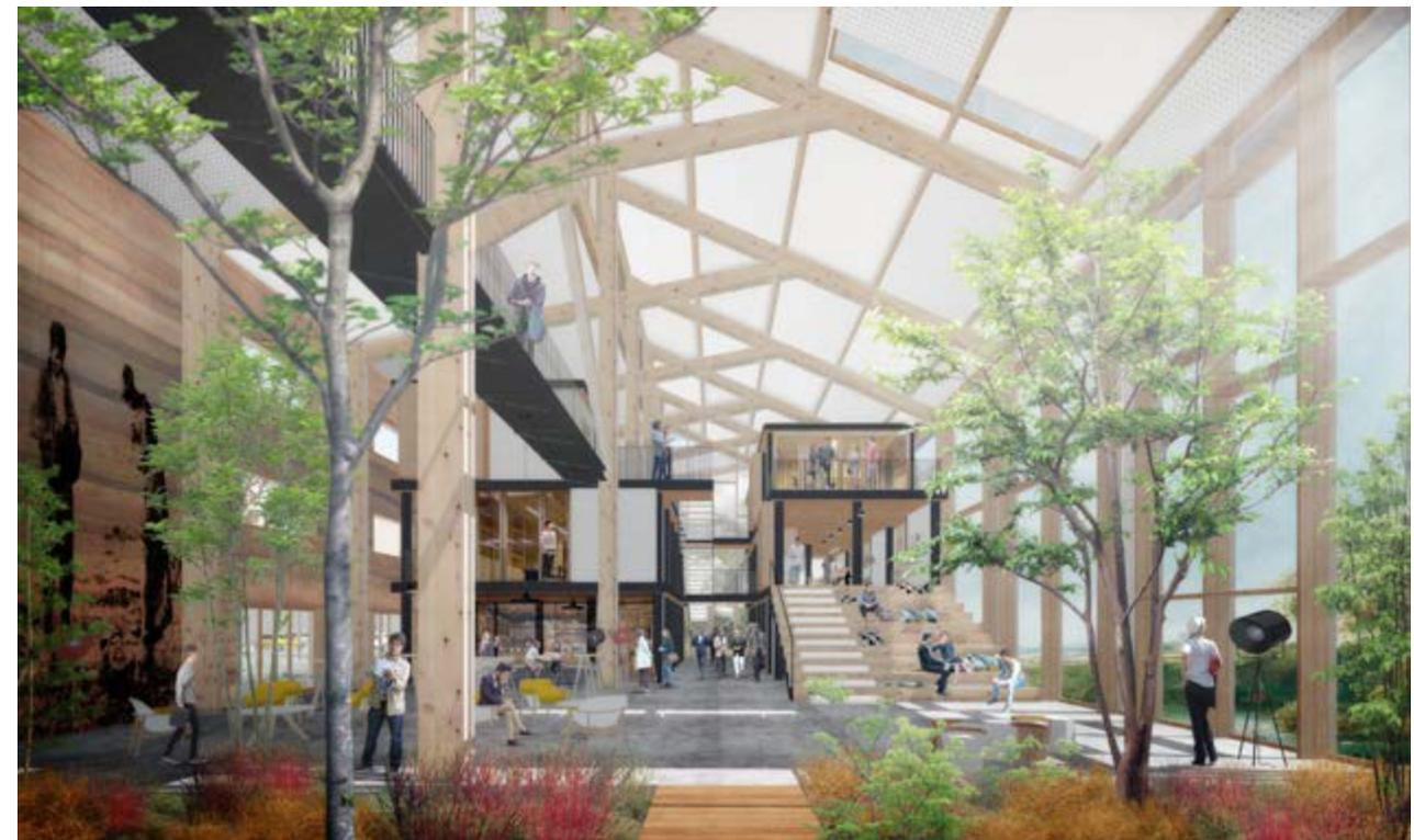
Construction d'un bâtiment tertiaire bas carbone dédié à l'accompagnement des entreprises vers l'économie circulaire. La Passerelle est conçue avec des matériaux bio-sourcés : une ossature en bois, une isolation en paille et des murs en briques de terre crue. Elle abritera des espaces de travail, de co-working, un incubateur de start-ups, des ateliers et formations et un espace événementiel. Labels : Cradle to Cradle et E3C2.
